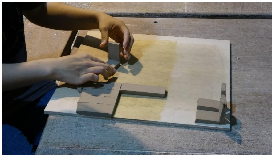
最後切割完的試片（長 10cm、寬 3cm，厚度 2cm）並蓋上印花章並對摺成 L 型及完成
