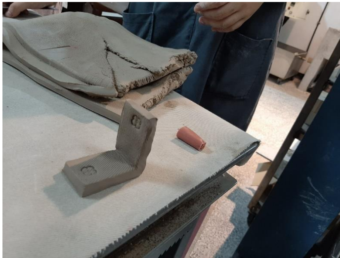
最後切割完的試片（長 10cm、寬 3cm，厚度 2cm）並蓋上印花章並對摺成 L 型及完成
