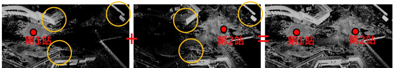
圖 3、點雲拼接 A(第一站)+B(第二站)=C(全部)概念
