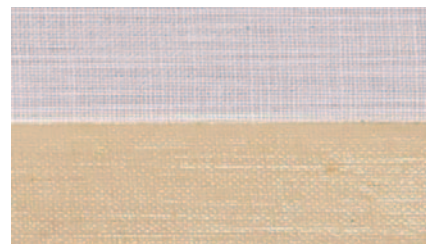
沾水式無酸性麻布膠帶，上為膠帶表面，下為膠帶塗膠面
